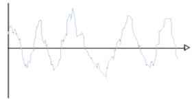
Cette représentation d'un son est appelée **spectre de modulation d'amplitude** (modulation de l'amplitude d'un son en fonction du temps). Le **sonogramme** représente par contre la variation des fréquences sonores en fonction du temps. On peut remarquer qu'un sonogramme présente une fréquence fondamentale, à laquelle se superposent des fréquences plus élevées, appelées harmoniques.
